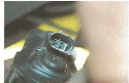
Vocht & corrosie in de elektronische stelmotor
